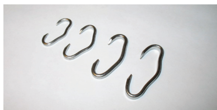
Рис. 2. Скоба из металла с памятью формы для заднего моносегментарного спондилодеза
